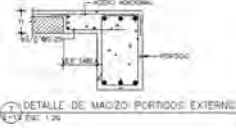
6 DETALLE DE MACIZO PORTICOS EXTERNOS E-13 ESC. 1:25
