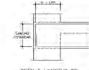
DETALLE LONGITUD DE DESARROLLO EXTREMO VIGA ESC. 1:20
